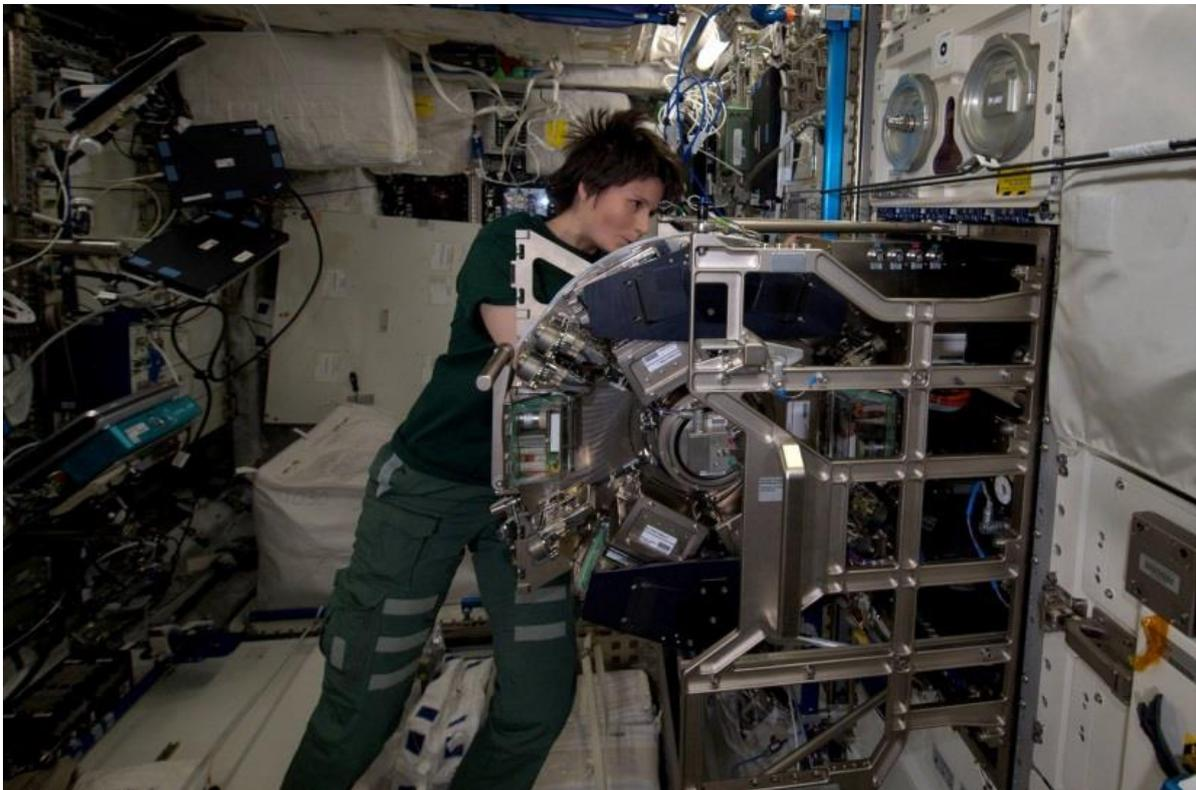
ESA-Astronautin Samantha Christoforetti bereitet den Rotor des BIOLAB für das TRIPLE LUX Experiment vor
